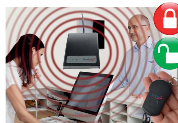
mit einem über USB angeschlossenen Lesemodul. Der PC-LOC Leser erzeugt ein stufenlos bis 120 cm Reichweite einstellbares Erfassungsfeld mit einer codierten wechselnden Nummer, einem zufällig erstellten Code, der nur von einem angelernten aktiven elektronischen Schlüssel entschlüsselt werden kann. Sobald der aktive Schlüssel korrekt geantwortet hat, wird der Bildschirm freigeschaltet.
