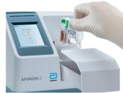
3. Testkassette einsetzen, Deckel schließen und Ergebnis nach kurzer Zeit ablesen
