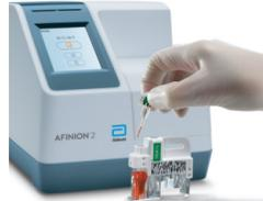
2. Die integrierte Kapillare sofort wieder in die Testkassette einsetzen.
