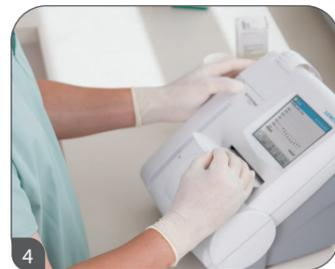
4 Klappe am System schließen. Der Test startet automatisch. Das Ergebnis ist nach 6 min. verfügbar.
