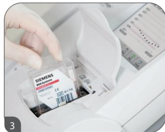
3 Reagenzkassette am System scannen und einsetzen.
