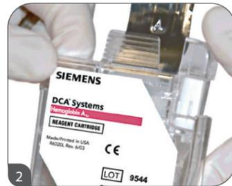
2 Nur 1µl Blut mit der Kapillare aufnehmen und Kapillare in die Reagenzkassette einsetzen.
